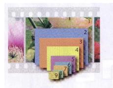
Sensorformate im Vergleich (Originalgröße): 1: Kleinbildformat (36 mm × 24 mm), 2: Canon EOS 1D (28,7 mm × 19,1 mm), 3: APS-C (23,5 mm × 15,6 mm), 4: Four-Thirds (17,3 mm × 13,0 mm), 5: Nikon-CX (13,2 mm × 8,8 mm), 6: 2/3" (8,8 mm × 6,6 mm), 7: 1/1,72" (7,5 mm × 5,5 mm), 8: 1/2,33" (5,6 mm × 4,2 mm), 9: 1/2,4" (5,4 mm × 4,1 mm) Bild aus Ct Digitale Fotografie 01/2012
